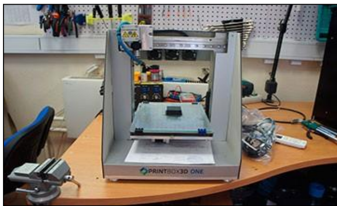
3D принтер PrintBOX 3D ONE технология печати FDM
