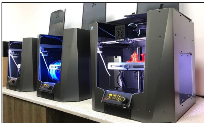
3D принтер Picaso 3D Designer X Pro технология печати FDM
